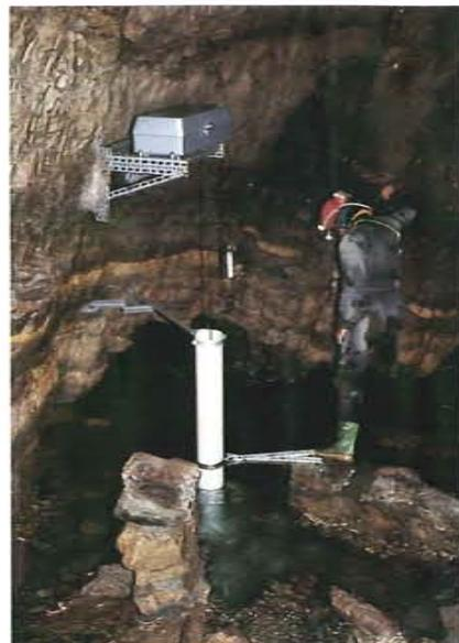
Idrometrografo installato in un collettore carsico.
